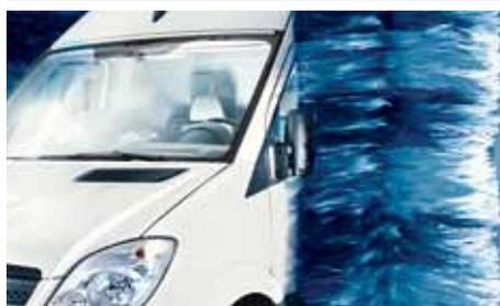
Grâce à un système de commande intelligente, le portique reconnaît automatiquement le type de véhicule pendant le lavage et enclenche de lui-même si besoin le programme spécial rétros sur les transporteurs. Le logiciel laisse ainsi tourner les brosses latérales vers l'avant et vers l'arrière de telle sorte qu'elles ne soulèvent pas les rétros rabattus.
