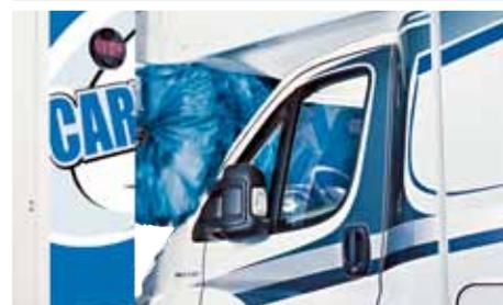
Avec le programme capucine, la brosse de toit est commandée en mouvement arrière depuis le pare-brise afin de contourner automatiquement la capucine. Ainsi, les fabricants, vendeurs ou loueurs de camping-cars peuvent maintenant remplacer le pénible lavage manuel par une opération simple et automatique avec la qualité WashTec.
