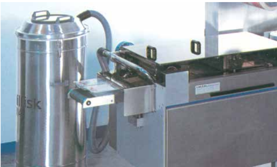
Récupération des déchets provenant des machines d'emballage
