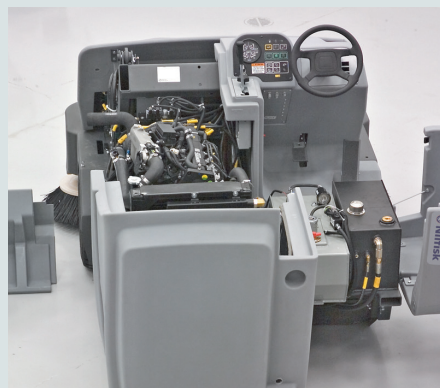
Le concept No Tools™ facilite la maintenance. La carrosserie s'ouvre totalement pour un accès complet au moteur et aux composants hydrauliques
