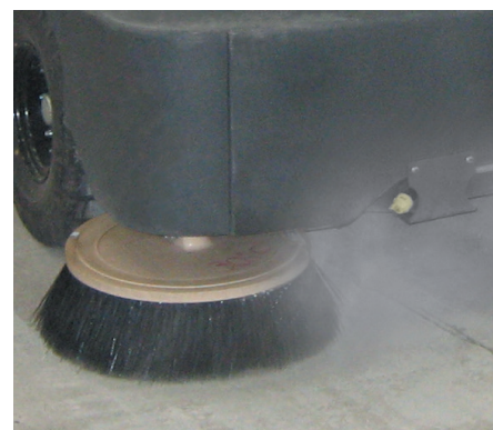
Le système exclusif DustGuard™ permet un contrôle total de la poussière au niveau des balais latéraux
