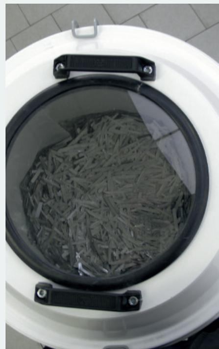
Un hublot sur le dessus de L'aspirateur permet de visualiser le niveau de déchets aspirés
