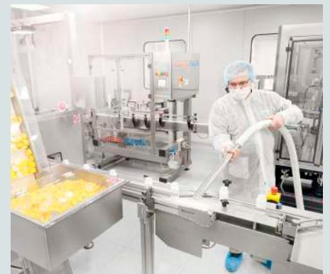
Récupération de poussière dans la production de compléments alimentaires.
