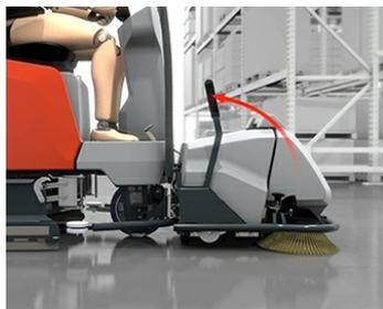
**Un seul passage :** facile à installer, le prébalayage permet de collecter la saleté avant le nettoyage à l'eau. Il peut être équipé du système Dust stop.
