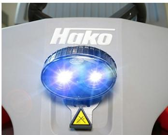
**Plus de sécurité dans les passages étroits :** le phare BlueSpot signale aux autres véhicules la présence de la machine.
