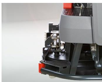
**Nettoyage jusqu'en bordure** grâce au système de brosse débordant du côté droit.
