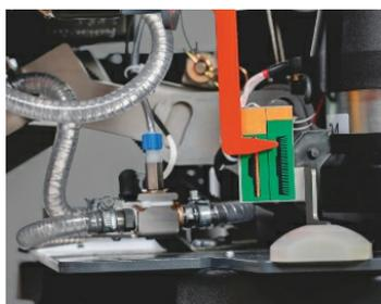
**Indicateur d'usure pour les brosses** et les disques et système d'accrochage et décrochage des brosses automatique.
